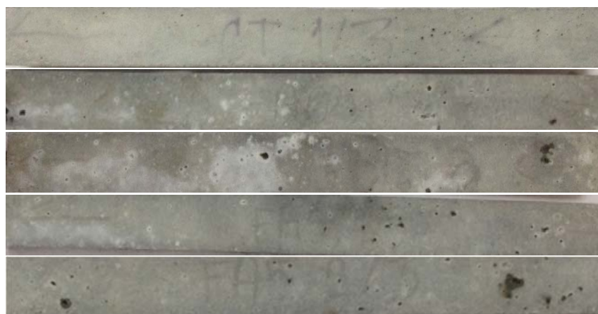
รูปที่ 3 ลักษณะผิวของมอร์ตาร์ควบคุม CT และมอร์ตาร์ที่ผสมเถ้าถ่านหินที่มีความละเอียดต่างกันหลังทดสอบการขยายตัวเป็นเวลา 28 วัน
