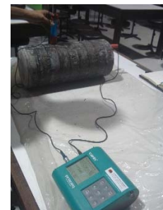
รูปที่ 4 ตัวอย่างและขั้นตอนการตรวจสอบแนวโน้มการรุกร่อนของเหล็กเสริมภายในเสาตัวอย่าง (หน่วย มม.)
