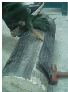
รูปที่ 4 ตัวอย่างและขั้นตอนการตรวจสอบแนวโน้มการรุกร่อนของเหล็กเสริมภายในเสาตัวอย่าง (หน่วย มม.)
