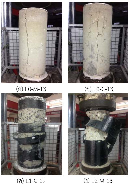
รูปที่ 13 ตัวอย่างลักษณะการวิบัติของคอนกรีตล้วนและคอนกรีตที่มีการโอบรัดด้วย CFRP
