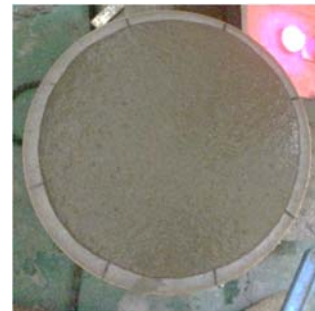
รูปที่ 3 การทดสอบการไหลแผ่ของมอร์ตาร์
