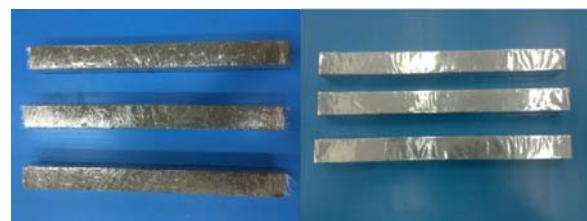
(a) การห่อหุ้มตัวอย่างด้วยพลาสติก 10 ชั้น (b) การห่อหุ้มตัวอย่างด้วยเทปอลูมิเนียม 2 ชั้น
