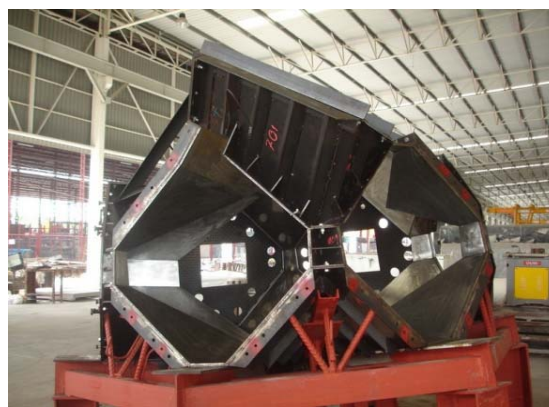
รูปที่ 26 แบบหล่อชิ้นส่วนจุดต่อ Node จัดทำพิเศษโดยมีผิวเหลี่ยมมุมที่ถูกต้อง และต่อเนื่องเป็นระนาบเดียวกันกับผิวของเสาเอียง คาน และพื้นอาคารที่จะมาเชื่อมต่อกันที่จุดต่อนี้
