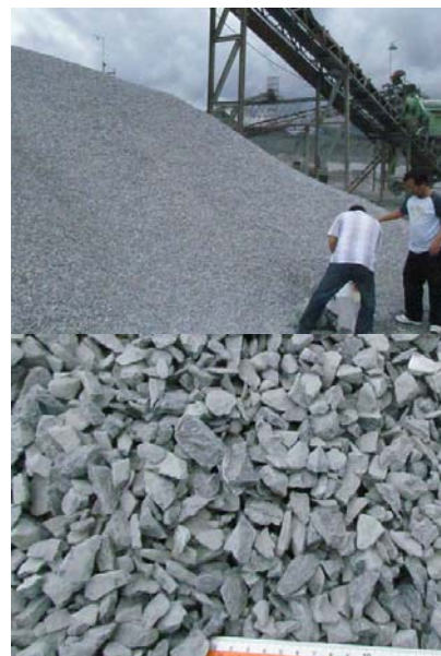
รูปที่ 1 การเก็บตัวอย่างมวลรวมและลักษณะตัวอย่างที่เก็บ
