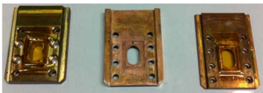
รูปที่ 3 ที่ใส่ตัวอย่างซีเมนต์เพสต์เหลวสำหรับวิเคราะห์ด้วยเทคนิค WAXS
