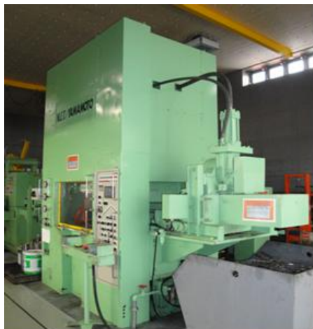
ภาพที่ 2 เครื่องไฮดรอลิกเพรสแบบสามจังหวะ ขนาด 400 ตัน
