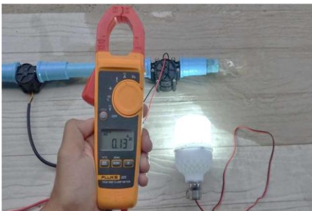
ภาพที่ 6 การวัดกระแสที่เกิดจากเจนเนอเรเตอร์ เมื่อมีน้ำไหลผ่าน
