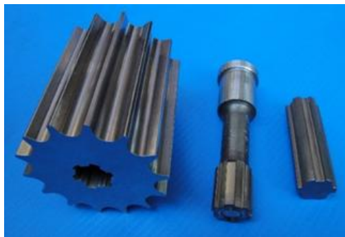
ภาพที่ 1 มุมขอบคมตัดของฟันซ์และตาย
