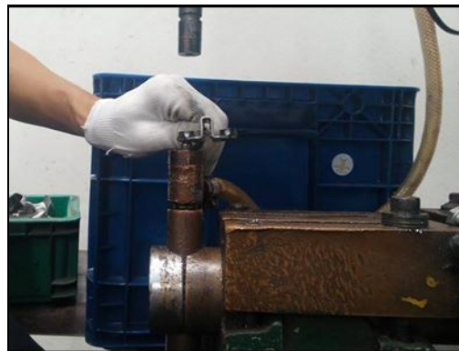
ภาพที่ 8 ลักษณะการเชื่อมแป้นเกลียวให้ติดกับตัวชิ้นงานด้านขวา
