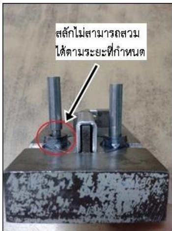
ภาพที่ 4 ชิ้นงานที่พบปัญหา รูไม่ตรงตำแหน่ง
