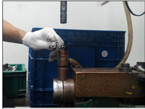
ภาพที่ 7 ลักษณะการเชื่อมแป้นเกลียวให้ติดกับตัวชิ้นงานด้านซ้าย
