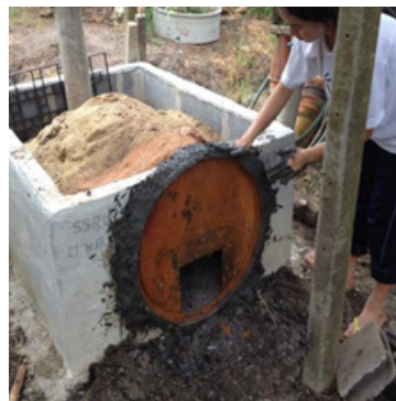
ดังรูปที่ 2 แสดงการจัดเรียงไม้และการปิดฝาเตา
