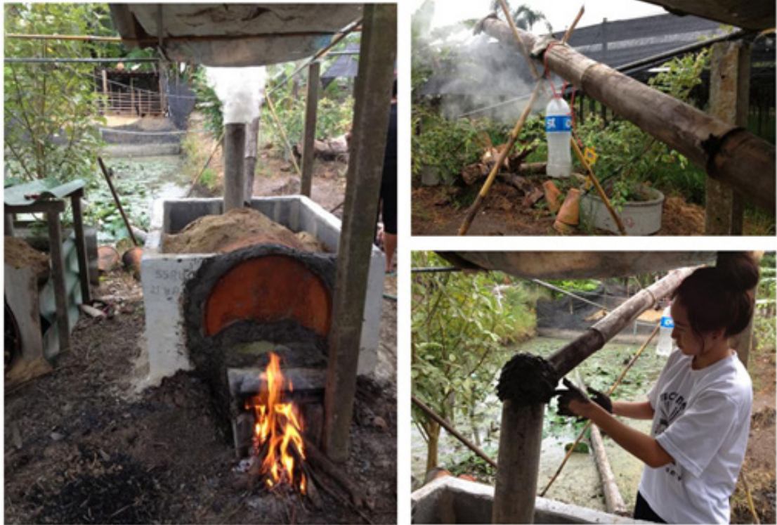
รูปที่ 3 แสดงการเผาไล่ความชื้นและการเก็บน้ำส้มควันไม้
