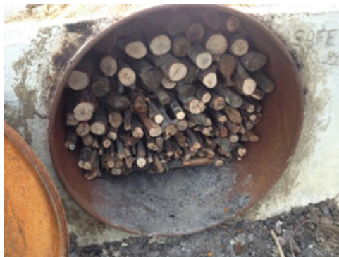
ดังรูปที่ 2 แสดงการจัดเรียงไม้และการปิดฝาเตา
