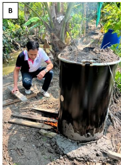
รูปที่ 2 การผลิตถ่าน A เศษกะลามะพร้าว B ให้ความร้อนเตาปฏิกรณ์ และ C ถ่านไบโอชาร์
