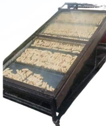
รูปที่ 4 การอบภายในตัวเก็บรังสีอาทิตย์
