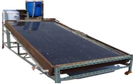
รูปที่ 1 เครื่องต้นแบบระบบบำบัดน้ำเสีย แสงอาทิตย์[6]
