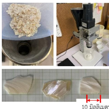
รูปที่ 4 การเตรียมเปลือกหอยและการทดสอบบดด้วยเครื่องแบบไจราทอรี
