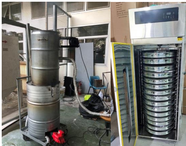
รูปที่ 2 ตู้อบแห้งที่สร้างขึ้น
