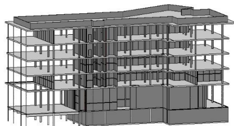
รูปที่ 2 แบบจำลองสารสนเทศอาคารคอนกรีตเสริมเหล็ก พักอาศัยกึ่งสำนักงาน 7 ชั้น
