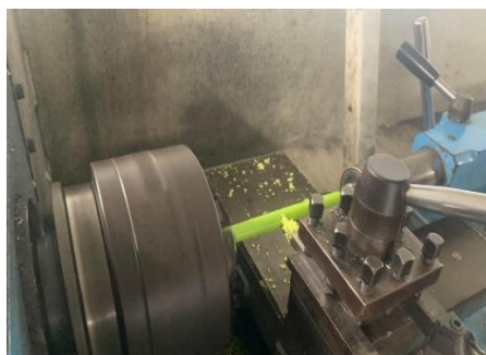
รูปที่ 4 การกลึงเส้นพลาสติก 100 % และกลึงเส้นพลาสติกผสมกับเส้นใยอ้อย และเลา
