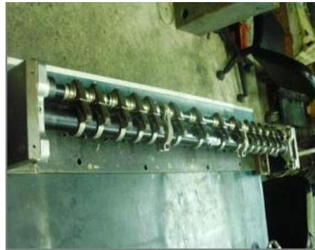
ภาพที่ 10 ทดสอบการใช้งานเครื่องมือช่วย ประกอบชุดราวกริบเปอร์พากระดาศ
