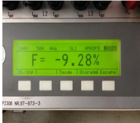
ภาพที่ 8 ค่าร้อยละความคลาดเคลื่อนที่วัดได้จากมิเตอร์ไฟฟ้ามาตรฐาน เมื่อมีลวดทองแดงต่อคร่อมจุดต่อสายระหว่างสายคอนโทรลเคเบิลเฟส A และ C
