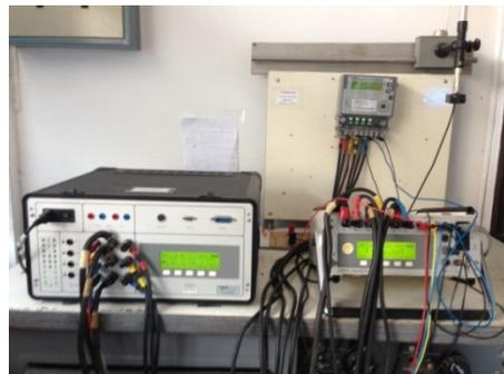
ภาพที่ 2 การต่อมิเตอร์ไฟฟ้าเข้ากับ Phantom Load และ Standard Meter
