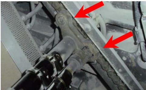
ภาพที่ 4 ตำแหน่งเดือยติดตั้งตัวเรือนรอง เพลลา(bearing housing) บนราวโซ่ส่วน รองรับ
