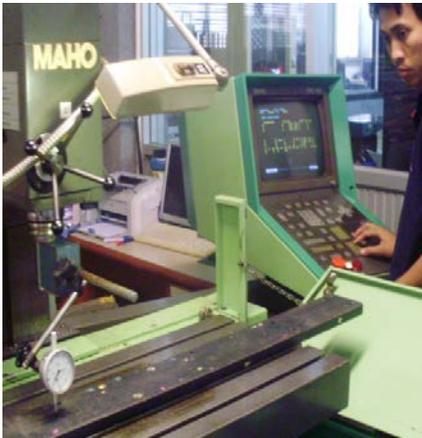
ภาพที่ 9 ตรวจสอบวัดความตรงความเรียบบน แทนด้วยนาฬิกาเทียบศูนย์
