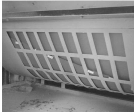
ภาพที่ 2 กระดาศขาดและหลุดที่เกิดจากราวกริปเปอร์พากระดาศไม่สมดุลกันระหว่างตัวเรือนรองเพลลาด้านซ้ายกับด้านขวา
