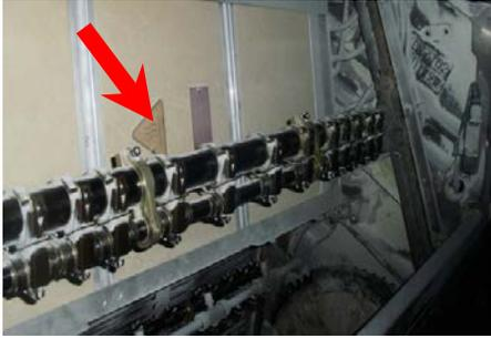
ภาพที่ 3 ลักษณะของชุดราวกริบเปอร์พา กระดาษที่ติดอยู่กับเครื่องพิมพ์ มิตซูบิชิ รุ่น ไดมอนด์ 3000
