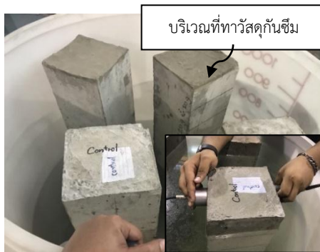
รูปที่ 3 แท่งคอนกรีตที่ทาวัดคลื่นซึ่มที่ผิวบน ในขณะที่แช่น้ำและวัดค่าความหนาแน่นด้วย UPV ที่ระยะทาง 20 เซนติเมตร
