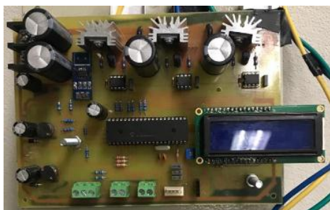
รูปที่ 3 อินเวอร์เตอร์ 3 เฟส สำหรับควบคุมความเร็วมอเตอร์ BLDC
