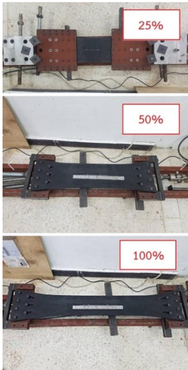
รูปที่ 2 การดึงแผ่นยางพาราโดยมีการยืดตัวของแผ่นยางเป็น 2 เท่าจากความยาวเดิม
