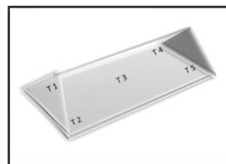
รูปที่ 5 ตำแหน่งการวางเทอร์โมมิเตอร์เพื่อวัดอุณหภูมิ ด้านบน 6 จุด ด้านล่าง 5 จุด
