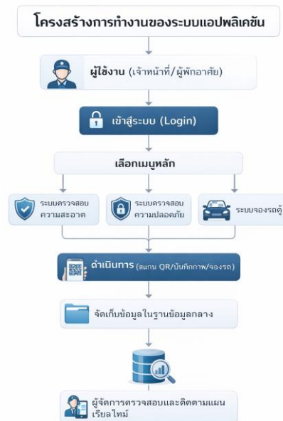
รูปที่ 2 โครงสร้างการทำงานของระบบแอปพลิเคชัน ที่มา: ผู้วิจัย
