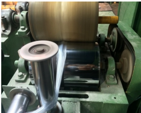
ภาพที่ 5 การทำงานของลูกกลิ้งควบคุมทิศทางเศษพลาสติกฟิล์มให้อยู่ในทิศทางที่บังคับ
