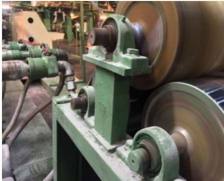
ภาพที่ 4 การปรับช่องว่างระหว่างลูกกลิ้งสามลูกและช่องว่างระหว่างลูกปืน
