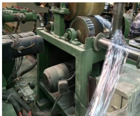
ภาพที่ 3 มอเตอร์ขับเคลื่อนกำลังขับเคลื่อนจะเกิดการดึงเศษพลาสติกฟิล์ม
