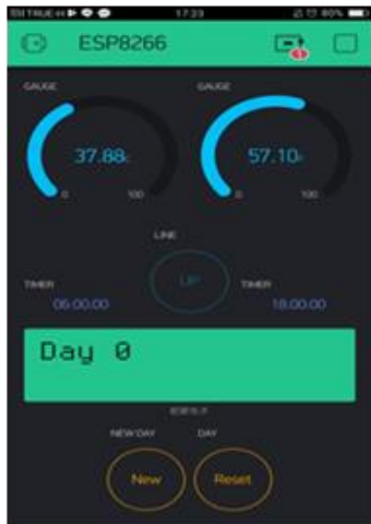
รูปที่ 8 ค่าอุณหภูมิและความชื้นผ่านแอปพลิเคชัน Blynk และการแจ้งเตือนผ่าน Line
