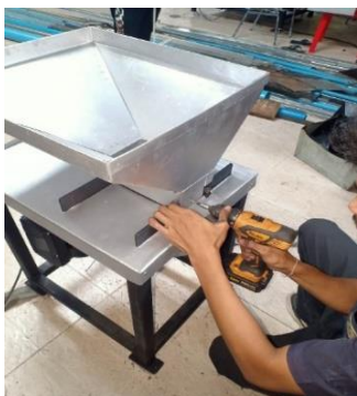
รูปที่ 8 ประกอบภาชนะวัสดุสำหรับเตรียมย่อย
