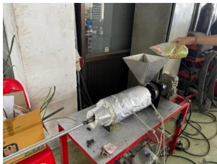
รูปที่ 3 การขึ้นรูปเส้นพลาสติก 100% และขึ้นรูปเส้นพลาสติกผสมกับเส้นใยอ้อย และเลา
