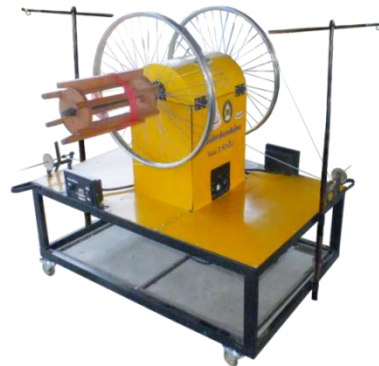
รูปที่ 8 เครื่องตีเกลียวเส้นไหมพุ่งแบบ 2 หัวปั่น
