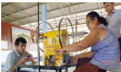
รูปที่ 10 การควบเส้นไหมสองสีผ่าน“เหล็กไน”
