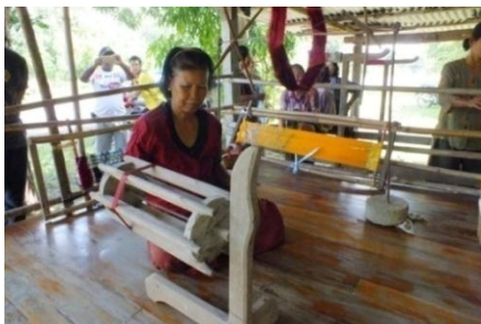
รูปที่ 1 กระบวนการ “กวก” เส้นไหมหลังการย้อม ออกจาก “กง” เข้าอ้ากรอ
