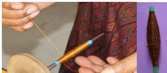
รูปที่ 13 การดัดเส้นไหมพุ่งเก็บเข้าหลอด
