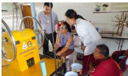
รูปที่ 11 การตีเกลียวเส้นไหมพุ่งเข้าอ้ากรอ
