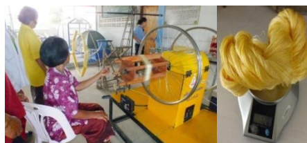
รูปที่ 9 การ “กวก” เส้นไหมหลังการย้อมออกจาก “กง” เข้าอัครกอ
