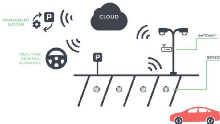
รูปที่ 4 ผังแนวคิดการทำงานของระบบผ่านเครือข่ายไร้สาย
