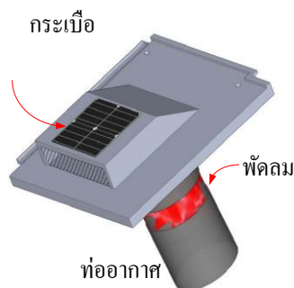
รูปที่ 1 กระเบื้องคอนกรีตระบายอากาศที่ติดตั้งพัดลมไฟฟ้าเซลล์แสงอาทิตย์
