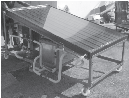
รูปที่ 2 เครื่องกลั่นเมทานอลออกจากไบโอดีเซลด้วยรังสีอาทิตย์
