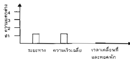
รูปที่ 8 เปอร์เซนต์ความแตกต่างของการวัดระหว่างเครื่องกับวิดีโอโดยถือค่าที่วัดจากวิดีโอเป็นหลัก
