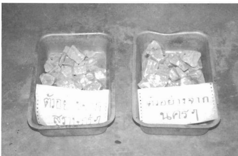
รูปที่ 1 ลักษณะแร่แอนไฮไดรต์ที่เตรียมเป็นก้อนตัวอย่างในการทดสอบ
