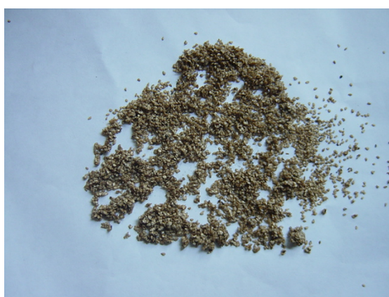
รูปที่ 12 แสดงลักษณะกากงาที่ได้จากการบีบอัด 1 รอบ
