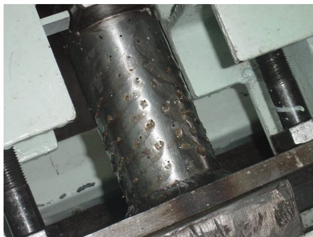
รูปที่ 7 แสดงกระบอกบีบเมล็ดงาขณะบีบอัด และน้ำมันงาไหลออกตามรูที่เจาะไว้
