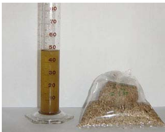
รูปที่ 11 แสดงกากงาและน้ำมันงาที่ได้จากการบีบงา 1 รอบ
