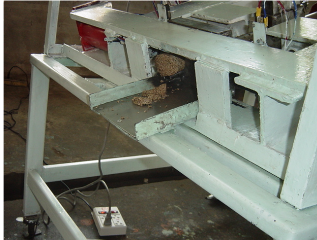
รูปที่ 9 แสดงการคายกากจากประตูคายกาก
