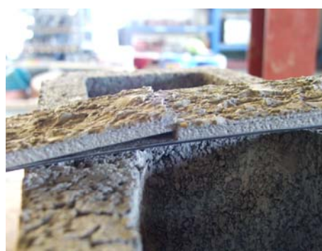
(b) Debonding ของแผ่น CFRP
