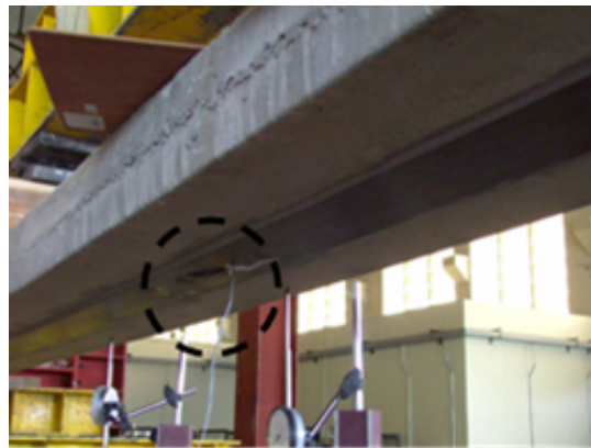
รูปที่ 3 การติดตั้งมาตรวัดความเครียดบนแผ่น CFRP ที่กึ่งกลางความยาวช่วงของแผ่นพื้น
