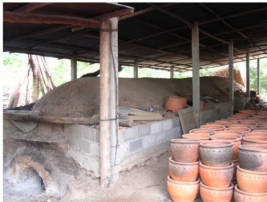
รูปที่ 1 เตาเผาดินด้านเกวียน (เตาจรวด) ที่ใช้ในงานวิจัยนี้
