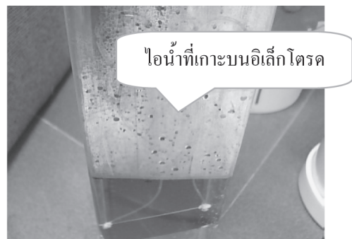
รูปที่ 13 ไอน้ำที่เกาะบนอิเล็กโทรด เมื่อน้ำมีอุณหภูมิมากกว่า 40 องศาเซลเซียส
