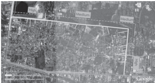
รูปที่ 7 ความถี่ทางเชื่อมของทางหลวง 4 ช่องจราจร มีฉนวนกั้นกลาง (ถนนหลังมหาวิทยาลัยขอนแก่น)
