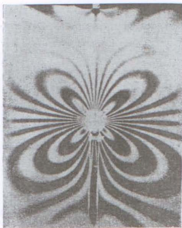
รูปที่ 4 Fringes ที่เกิดขึ้นจากการ ใส่ Moment เข้าไปใน Interior Column ของ Plate
