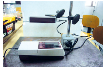
รูปที่ 3 เครื่องวัดค่าความขรุขระผิว ยี่ห้อ Mitutoyo Surf test SJ-210
