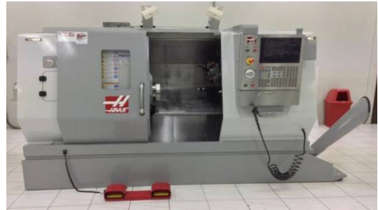
รูปที่ 2 เครื่องกลึงอัตโนมัติ CNC ยี่ห้อ Haas รุ่น SL20
