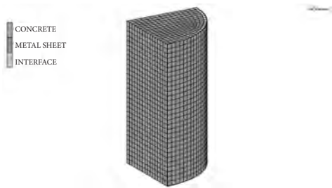
รูปที่ 9 การแบ่งอีลิเมนต์และวัสดุในแบบจำลองเสาหน้าตัดวงกลมที่โอบรัดด้วยเมทัลชีท 1 ชั้น
