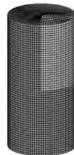
รูปที่ 5 แบบจำลองทางกายภาพ 1 ใน 8 ของตัวอย่างเสา คอนกรีตหน้าตัดวงกลม
