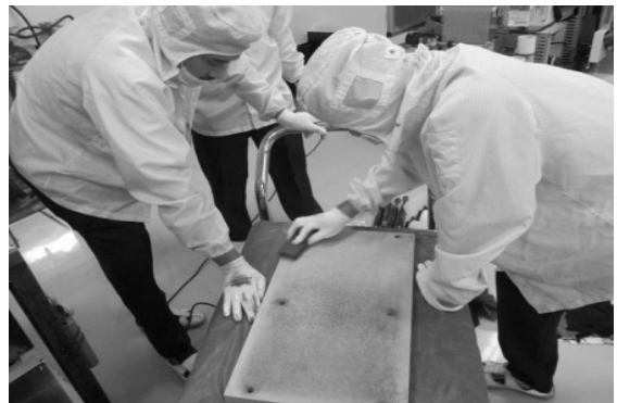
รูปที่ 13 การขัดระนาบของแผ่นอัดร้อน
