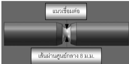
รูปที่ 4 ลักษณะรอยบากของชิ้นงานเชื่อมที่ผ่านการกลึงเพื่อกำหนดจุดขาด
