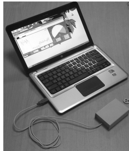
รูปที่ 8 อุปกรณ์ที่พัฒนาขึ้นทำงานร่วมกับคอมพิวเตอร์เพื่อสำรวจรังสี
