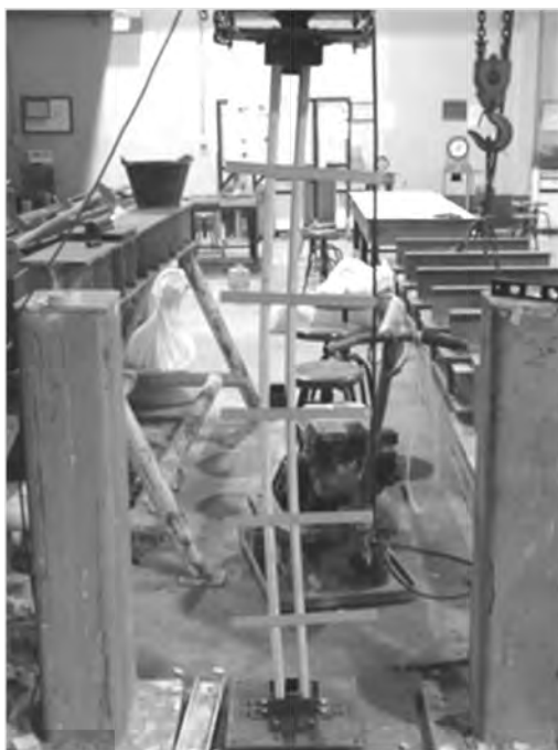
รูปที่ 9 ลักษณะการบิดตัวของตัวอย่างทดสอบยาวแบบ individual parallel buckling
