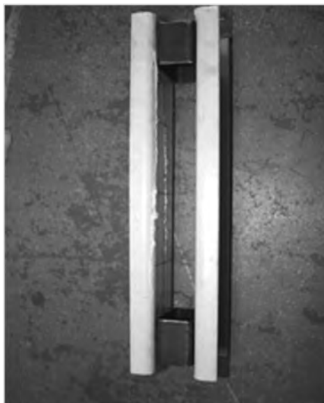
รูปที่ 7 ลักษณะการวิบัติโดยวัสดุของตัวอย่างทดสอบเสาแบบสั้น
