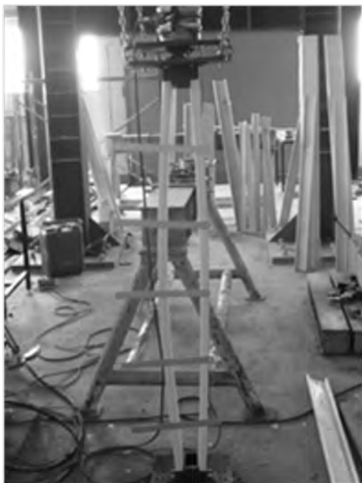
รูปที่ 8 ลักษณะการบิดตัวของตัวอย่างทดสอบยาวแบบ individual opposite buckling
