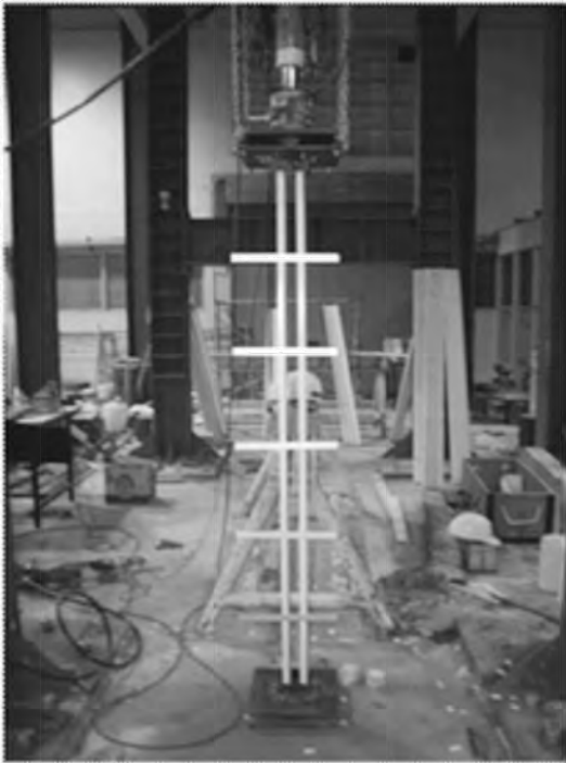
รูปที่ 4 การติดตั้งตัวอย่างทดสอบPFRP หน้าตัดรูปรางน้ำคู่ภายใต้แรงอัดในแนวแกน
