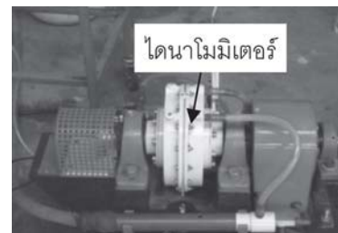
รูปที่ 5 ไดนาโมมิเตอร์ที่ต่อกับเครื่องยนต์ที่ใช้ทดสอบ
