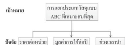
รูปที่ 1 โครงสร้างการวิเคราะห์น้ำหนักปัจจัยโดยใช้ AHP
