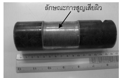
รูปที่ 3 แสดงลักษณะผิวที่สูญเสียของสลักข้อโซ่
