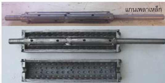
รูปที่ 1 แม่พิมพ์ลูกกลิ้งที่ประกอบด้วยฐานแม่พิมพ์ (Mould base) และแม่พิมพ์ลายลูกกลิ้งแบบผิวขนไค้ (A) แบบพื้นเลื่อย (B) และแบบสี่เหลี่ยม (C)
