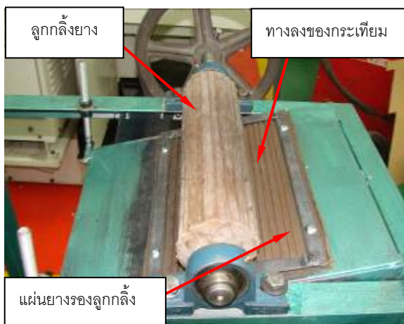
รูปที่ 7 การติดตั้งลูกกลิ้งบนเครื่องแกะกระเทียมเพื่อทดสอบการใช้งานจริงลูกกลิ้งยาง
