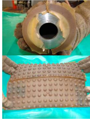
รูปที่ 6 แผ่นรองลูกกลิ้งที่พร้อมจะนำไปยืดบนแผ่นเหล็ก
