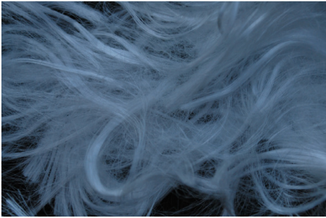
รูปที่ 5 เส้นใยสังเคราะห์ ชนิดPolyethylene fiber
