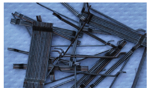
รูปที่ 4 เส้นใยเหล็ก ชนิดCrimped-end steel fiber
