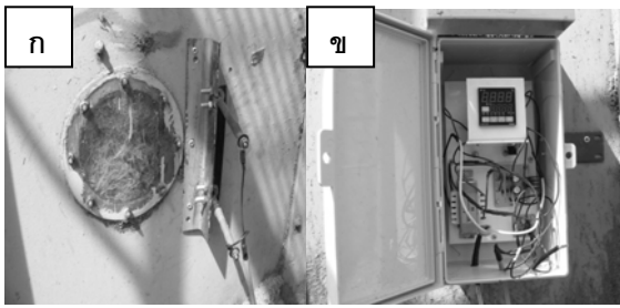
รูปที่ 7 (ก) หัวโพรบวัดความชื้นของขานอ้อยก่อนอบและ (ข) อุปกรณ์ต่อเชื่อมเครื่องวัดความชื้น
