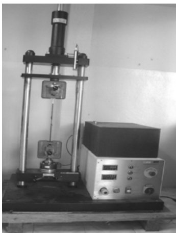
รูปที่ 8 การทดสอบแรงดึงของรอยเชื่อม
