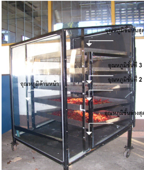
ภาพที่ 3 แสดงตะแกรงสแตนเลสที่ใช้ในการบรรจุและตำแหน่งการวัดอุณหภูมิ
