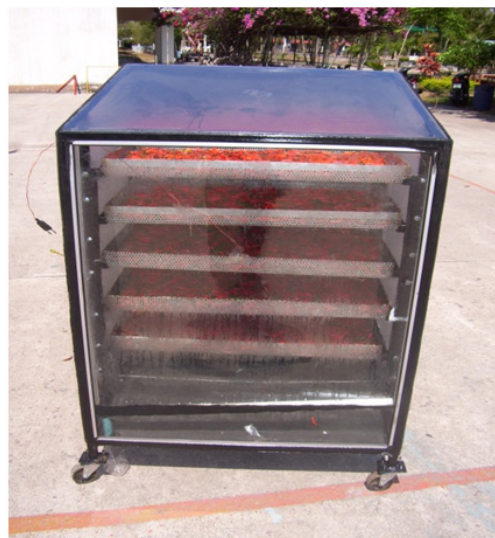
รูปที่ 1 ตู้อบแห้งและกลั่นความชื้นรังสีอาทิตย์แบบเทอร์โมไซฟอน
