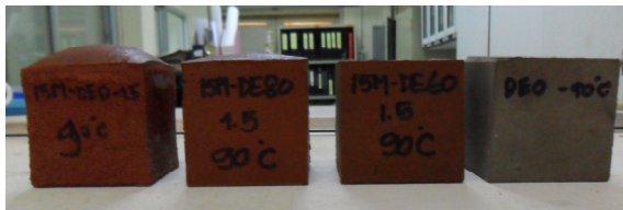
รูปที่ 12 ผลกระทบของอุณหภูมิการเร่งปฏิกิริยาต่อจีโอโพลิเมอร์มอร์ตาร์
