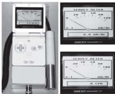
รูปที่ 5 เครื่องสำรวจรังสีที่ทำงานร่วมกับเครื่องเล่นเกมบอยที่พัฒนาขึ้น
